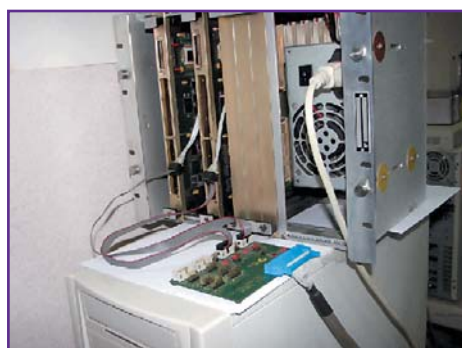
Рис. 14. Стенд для проверки модулей BT23-202 при помощи метода периферийного сканирования
