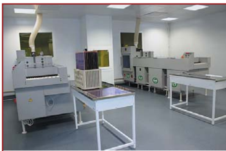
Рис. 4. Линия проявления СПФ и защитной маски
