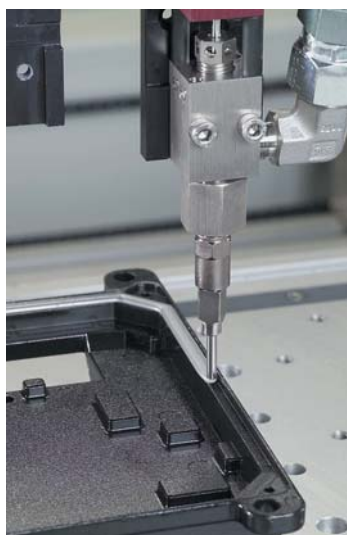
Рис. 8. Нанесение компаунда (насадка прямого дозирования серии FC100)
