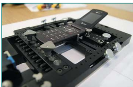
Рис. 13. Фиксатор мобильного телефона
