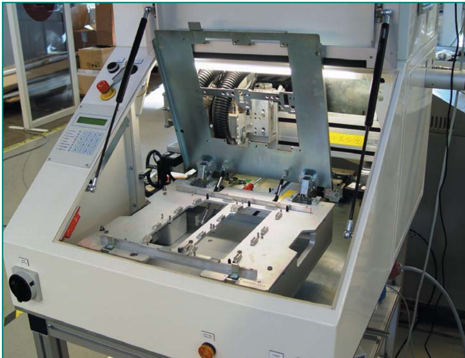
Рис. 17. Автономный роутер J501-41 (вид с открытой системой загрузки)
