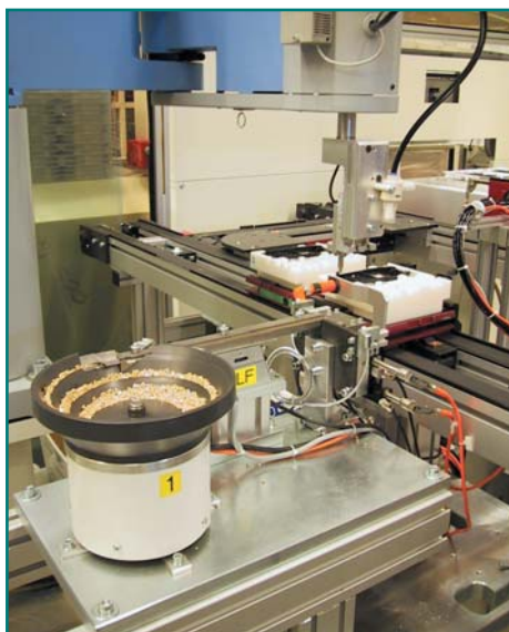
Рис. 9. Система автоматической работы с россыпью
