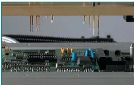
Рис. 11. Функциональный тестер (внутри)
