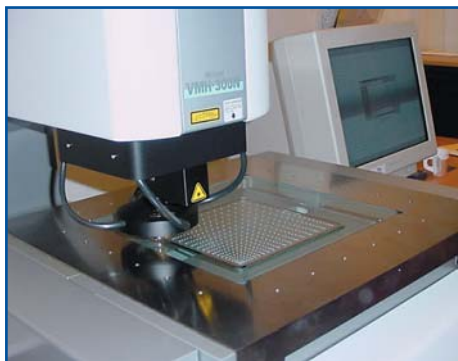
Рис. 2. Координатно-измерительная машина NIKON, используемая в компании MYDATA
