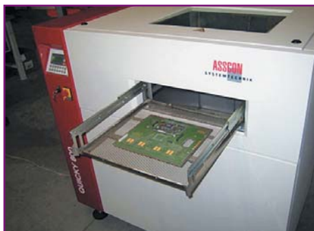
Рис. 16. Конденсационная печь VP-800 компании ASSCON
