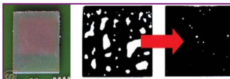
Рис. 5. Припаянный кристалл; паяное соединение, изготовленное при нормальном давлении; паяное соединение, изготовленное при повышенном давлении
