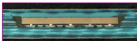
Рис. 4. Интеграция кристалла в печатную плату (источник: компания Würth Elektronik)
