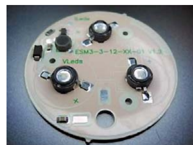
Рис. 10. Применение реакционных паяльных паст в светодиодной технике
