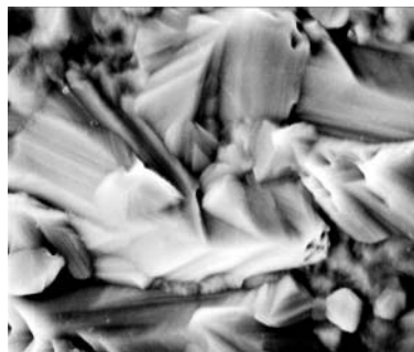
Рис. 8. Покрытие иммерсионного олова на медь с использованием органического металла в качестве барьерного слоя (большие плотно упакованные кристаллы)
