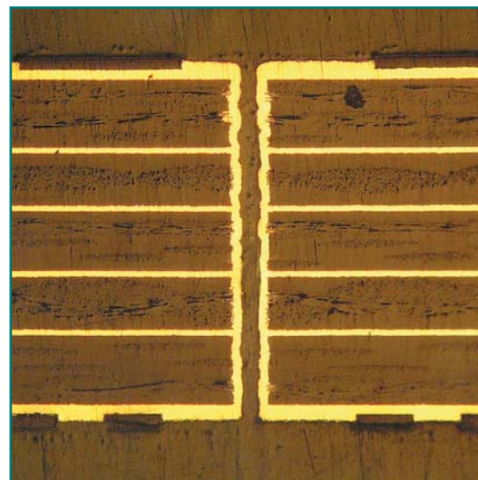
Рис. 2. Диаметр отверстия 0,1 мм. Соотношение диаметра отверстия к толщине платы — 1:12. Плата изготовлена на ФГУП ГРПЗ (г. Рязань)
