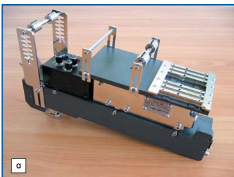
Рис. 11. Пенальный вибропитатель с регулируемыми «дорожками» для захвата компонентов
