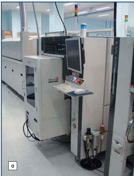
Рис. 10. Питатели для поддонов с микросхемами: а) модель TF5 с автоматической подачей; б) стол, устанавливаемый на базу; в) дополнительный стол с установкой в рабочую зону
