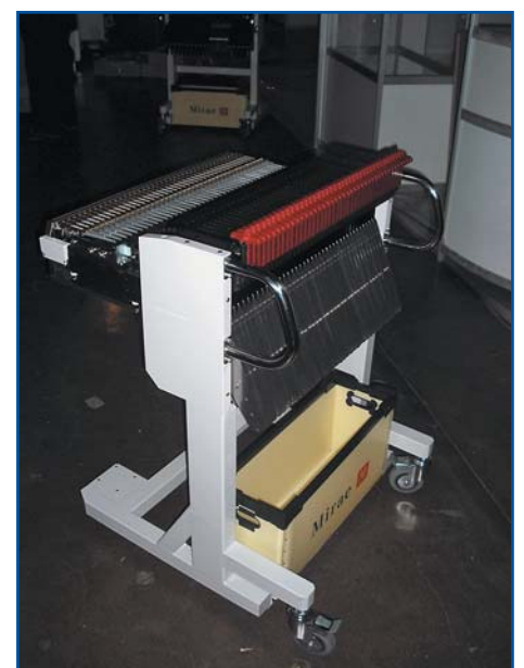
Рис. 12. Тележка для загрузки питателей
