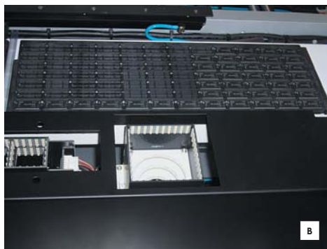
Рис. 10. Питатели для поддонов с микросхемами: а) модель TF5 с автоматической подачей; б) стол, устанавливаемый на базу; в) дополнительный стол с установкой в рабочую зону
