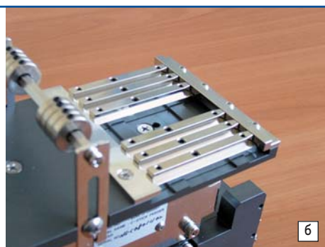
Рис. 11. Пенальный вибропитатель с регулируемыми «дорожками» для захвата компонентов
