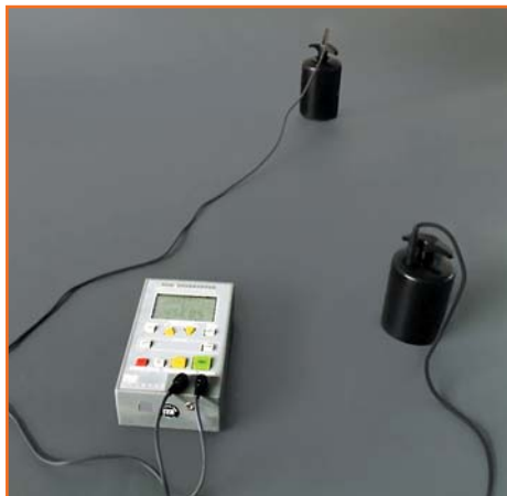
Рис. 2. Один из профессиональных приборов для измерения поверхностного сопротивления покрытия
