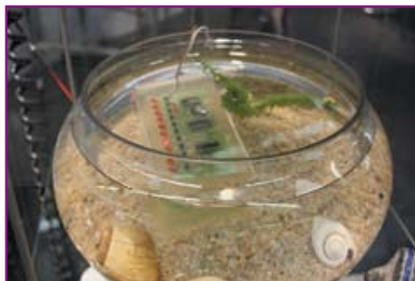
Рис. 9. Электронный модуль с защитным покрытием в аквариуме
