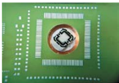
Рис. 8. Печатная плата со встроенным RFID-транспондером
