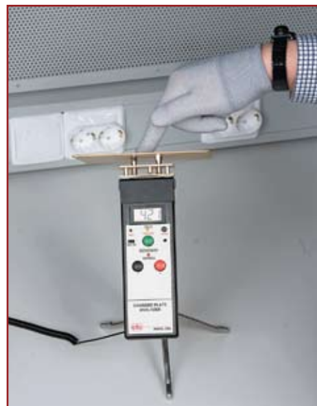
Рис. 8. Измерение прибором ETS-216 времени стекания заряда с антистатических перчаток
