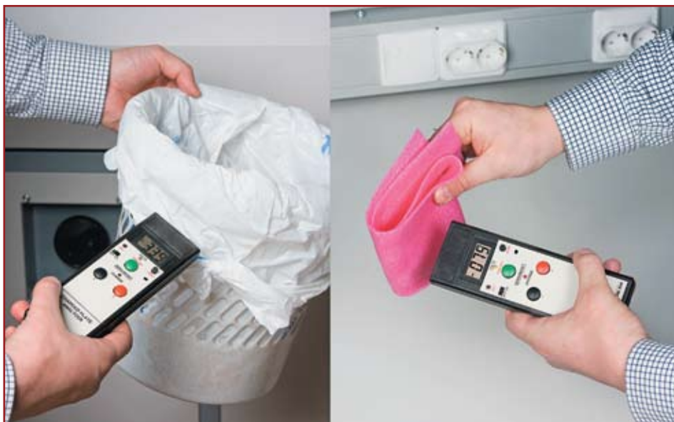
Рис. 7. Измерение прибором ETS-216 электростатического потенциала предмета
