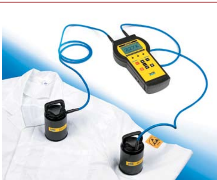
Рис. 5. Измерение сопротивления антистатического халата
