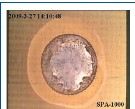
Рис. 5. Пример недостаточной смачиваемости припоя
