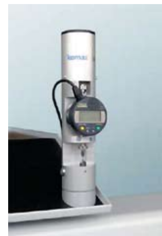
Рис. 3. Интегрированный в машины Kotha микрометр для определения высоты опрессовки контакта
