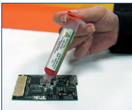
Рис. 4. Установка электрорадиоэлементов на печатную плату с помощью клея “Ероху 4044” фирмы AIM
