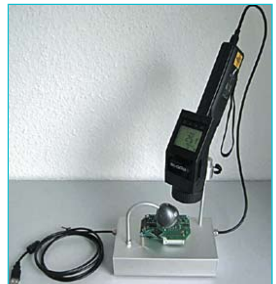
Рис. 1. Крепление пирометра Optris LS на штативе на расстоянии 62 мм для обеспечения минимального контролируемого пятна измерения
