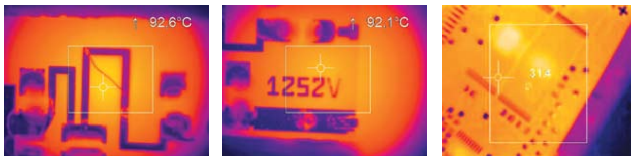
Рис. 4. Термограммы различных объектов, отображающие качество получаемого изображения с тепловизора с матрицей 160 \times 120 элементов
