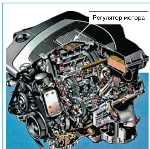
Рис. 1. Частичное представление разреза блока двигателя с модулем управления [1]
