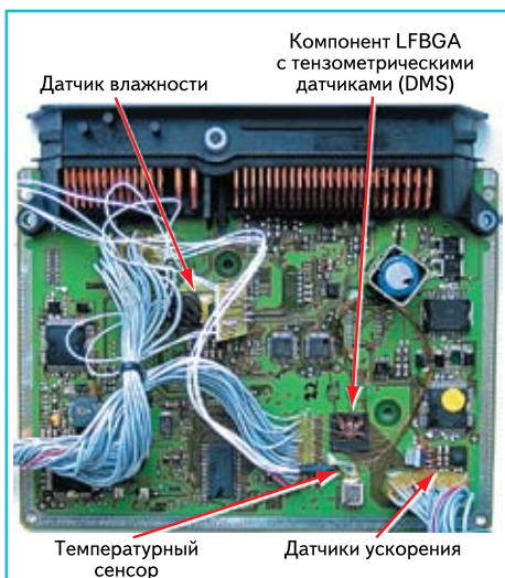
Рис. 3. Печатная плата модуля управления, модифицированная при помощи сенсоров, для получения данных в полевых условиях
