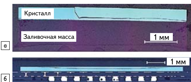
Рис. 12. Горизонтальная трещина: а) в структуре, состоящей из кремниевого кристалла и заливочной массы; б) в микрочипе электронного компонента LFBGA
