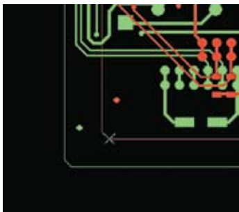
Рис. 2. Здесь в качестве точки выравнивания выбрана одна из вершин контура платы, расположенного на красном слое
