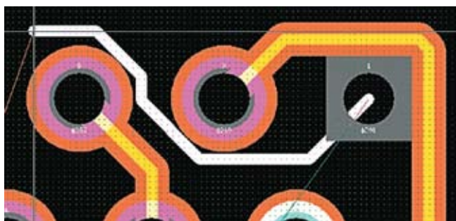
Рис. 10. Режим прорисовки проводников Pull Tight
