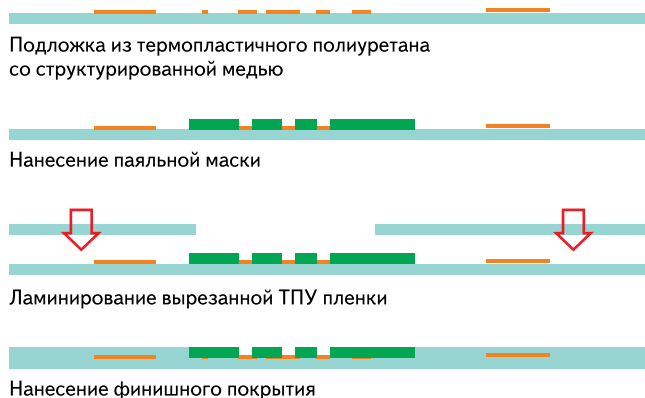
Рис. 1. Процесс изготовления растяжимых печатных плат
