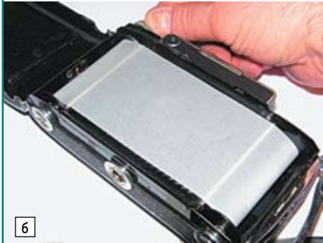
Рис. 2. Заправка калки в аппарат для наводки на фокус
