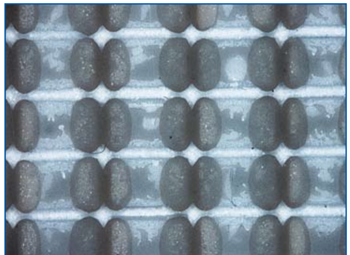
Рис. 11. Результаты эксперимента на установке струйной отмывки с форсунками, плавно и поступательно перемещающимися в плоскостях, параллельных отмываемым изделиям
