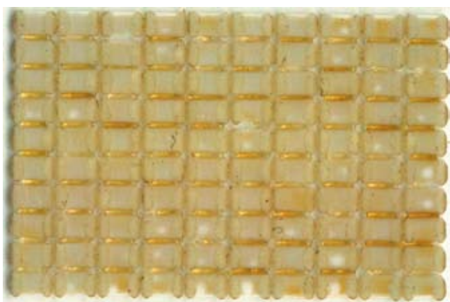
Рис. 12. Результаты эксперимента по технологии «струи в объеме». Очевидны остатки флюса как между чипами, так и под ними
