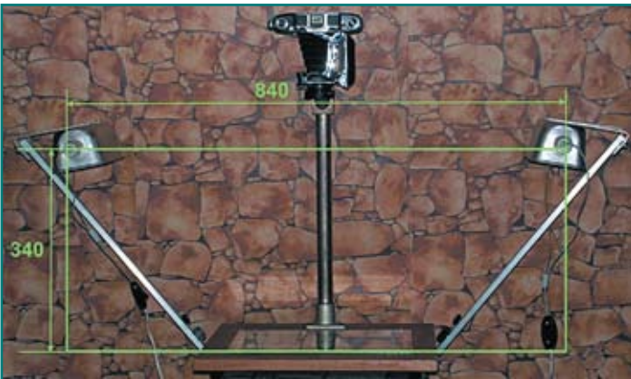
Рис. 23. Фоторепродукционная установка (стрелками показаны расстояние между осветителями и их высота над столиком)
