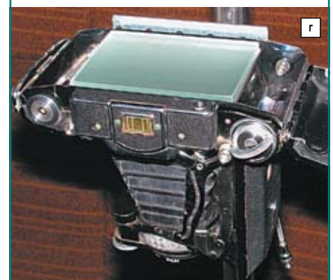
Рис. 24. Установка прозрачного стекла на столик и матового — на аппарат
