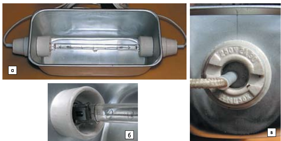
Рис. 20. Укрепление лампы КГ220-1000 с помощью фарфоровых патронов для ламп-миньонов: а) общий вид осветителя; б) вид на патрон со стороны лампы; в) вид со стороны провода
