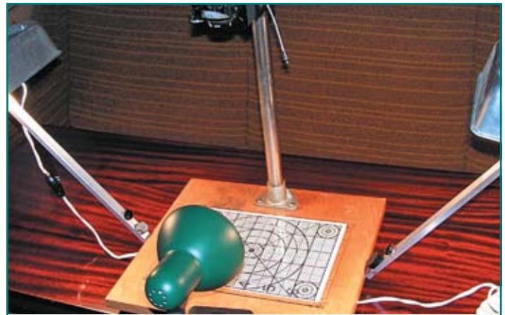
Рис. 25. Освещение оригинала лампами КГ220-1000
