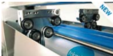
Рис. 4. Конвейерная система внутри системы контактной очистки Teknek
