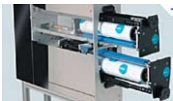
Рис. 3. Простая смена рулонов с адгезивным полимером в системах Teknek
