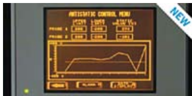
Рис. 6. Измерение заряда статического электричества в системе контактной очистки компании Teknek
