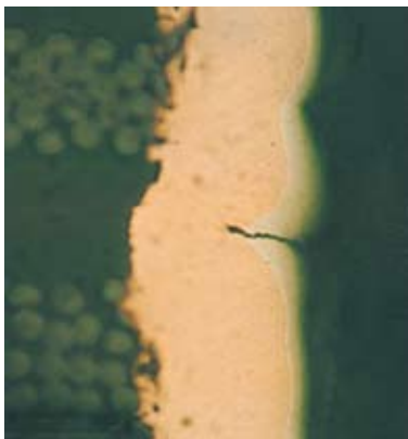
Рис. 9. Согласно IPC-A-600H трещина в металлизации стенки не допускается для всех классов (сравните с рис. 4)
