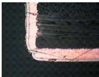
Рис. 5. Трещина металлизации на кромке металлизированного отверстия
