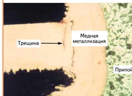
Рис. 8. Трещина в фольге при определенных условиях может допускаться для класса 1, но не для классов 2 и 3 (сравните с рис. 3)
