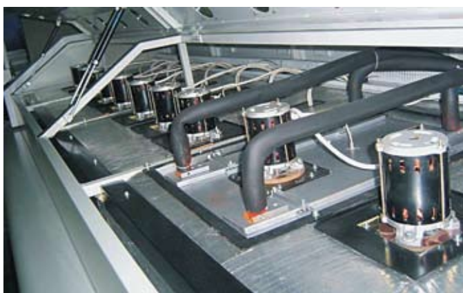
Рис. 2. Вентиляторы, обеспечивающие высокую однородность распределения теплового потока
