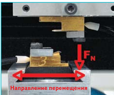
Рис. 1. Конструкция для моделирования линейного относительного движения между двумя образцами
