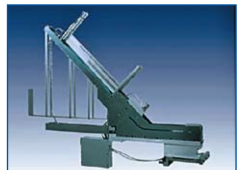
Рис. 5. Питатель для подачи компонентов из пеналов, расположенных под углом
