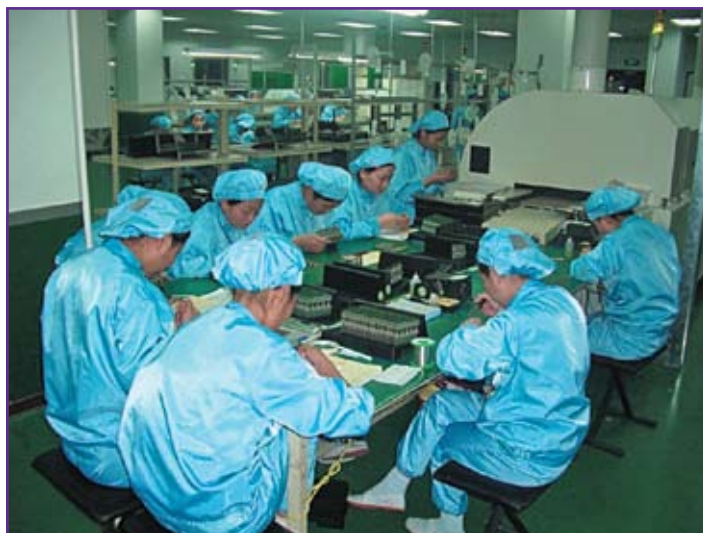
Рис. 1. Тотальный визуальный контроль ПУ после пайки
