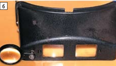
Рис. 45. Паяльные очки с замененной лупой: а) лупа задействована; б) лупа не используется
