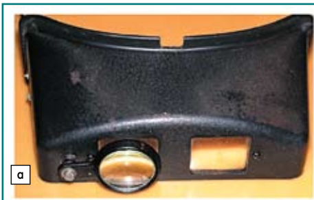
Рис. 44. Специальная ювелирная просмотровая лупа \times 10
