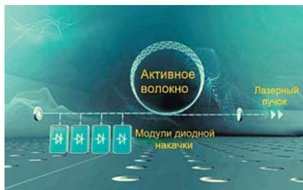
Рис. 2. Схема волоконного лазера с диодной накачкой
