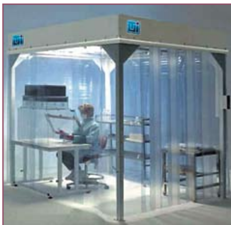
Рис. 1. Модульное чистое помещение
