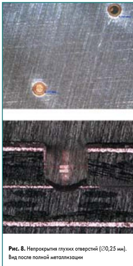
**Рис. 8.** Непокротия глухих отверстий (Ø0,25 мм). Вид после полной металлизации
