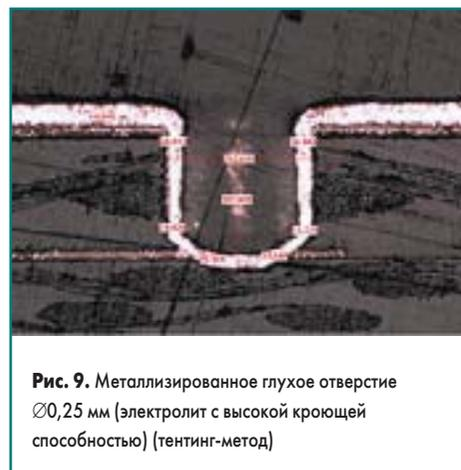
**Рис. 9.** Металлизированное глухое отверстие Ø0,25 мм (электролит с высокой кроющей способностью) (тентинг-метод)
