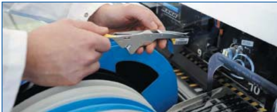
Рис. 3. Загрузка питателя Agilis во время работы машины
