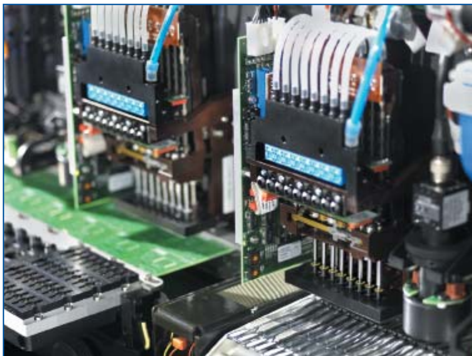
Рис. 7. Двойной блок монтажных головок в установщиках MY100HXe и MY100DXe
