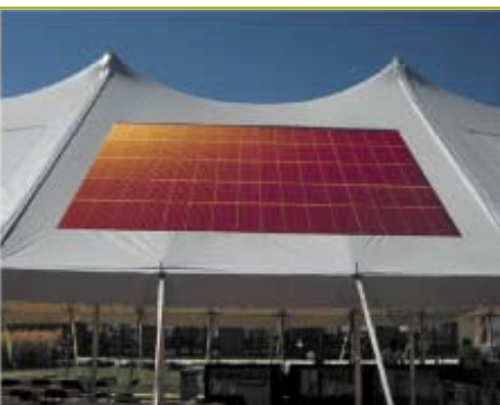
Рис. 6. Гибкие органические солнечные батареи производства компании Konarka (источник: Konarka)
