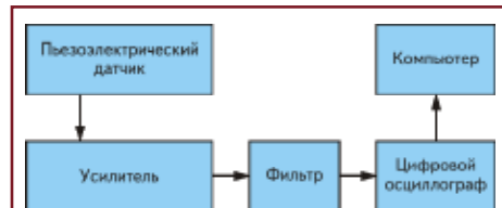
Рис. 3. Система мониторинга УЗ-сварки
