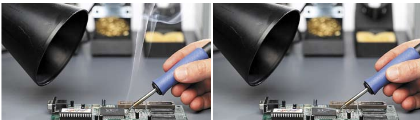
Рис. 11. Задымление при пайке с выключенным и включенным дымоуловителем VOFA
