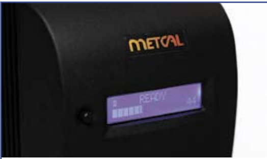
Рис. 3. Индикатор мгновенной мощности станции METCAL MX-5000
