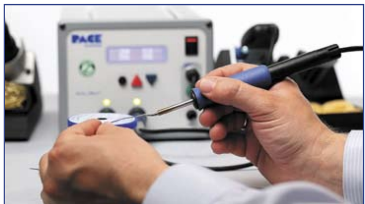
Рис. 7. Динамический паяльник PACE TD100 с наконечником «мини-волна»
