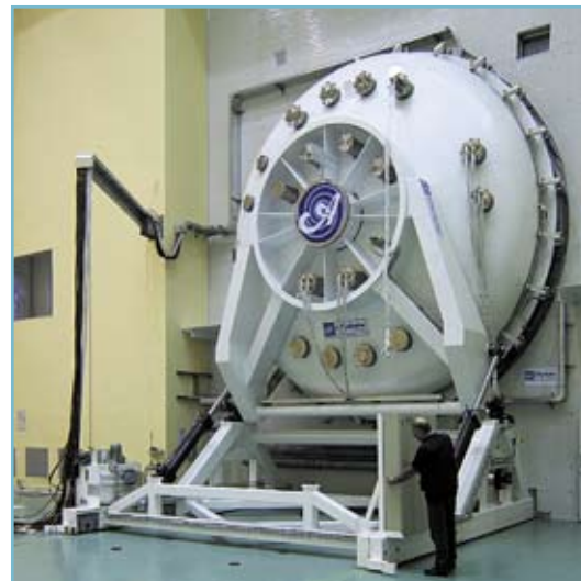
Рис. 2. Термовакуумная камера рекордной вместимости НТ400 МС
