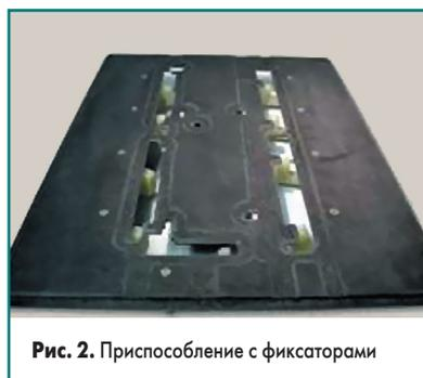
Рис. 2. Приспособление с фиксаторами
