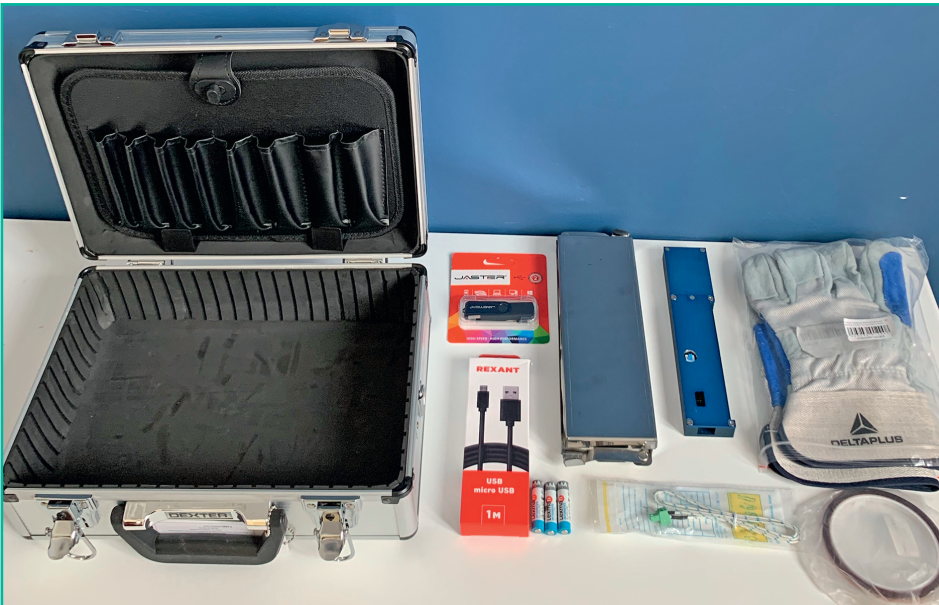
Рис. 2. Комплект поставки термопрофайлера САХАРА Т8-20
