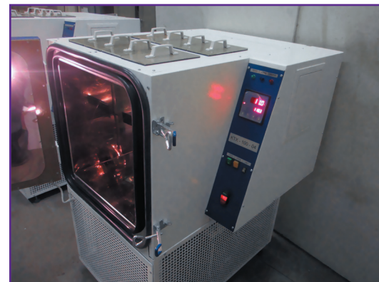
Рис. 2. Камера со шлюзами
