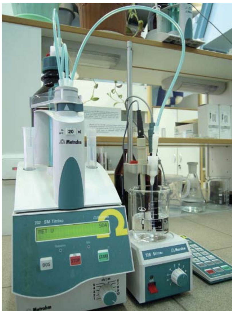
Рисунок. Автоматический титратор Titrino 702 SM
