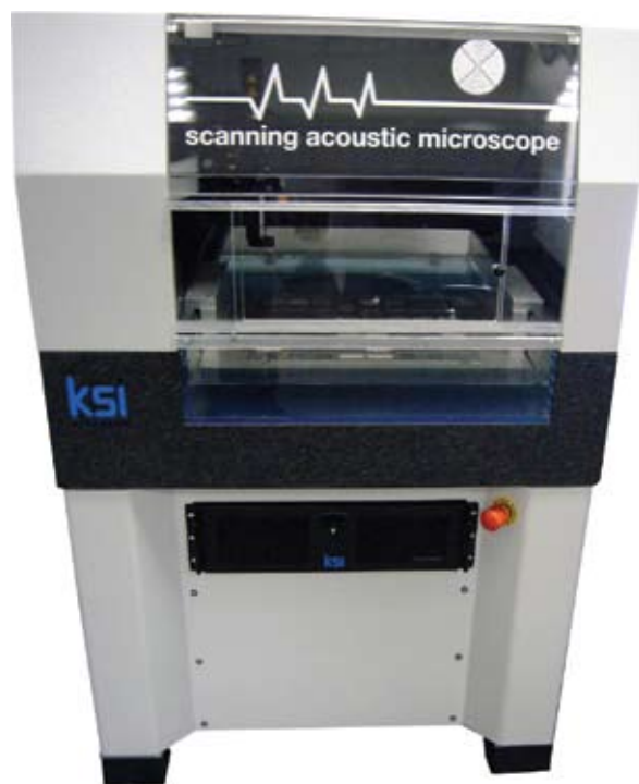
Рис. 2. Новейший универсальный многоканальный сканирующий акустический микроскоп KSI V8 для контроля качества материалов и электронных модулей
