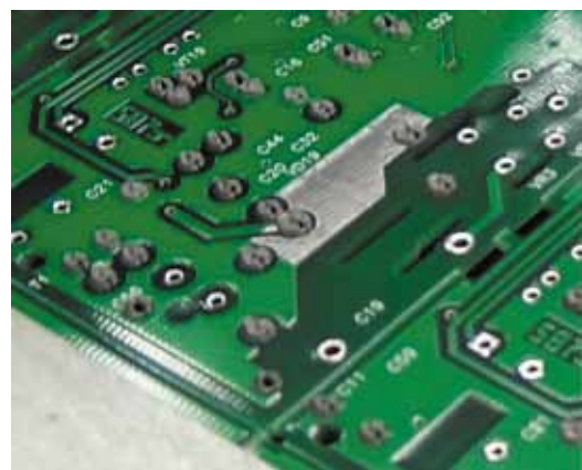
Рис. 5. Нанесение паяльной пасты через трафарет по технологии PiP
