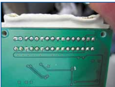
Рис. 3. Пример разъема, не выдержавшего температуры оплавления больше +200 °С
