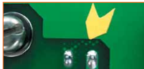
Рис. 4. Пятнистость — состояние, которое может возникнуть при неправильном ремонте (изображение из стандарта IPC-A-610E)
