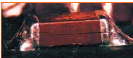
Рис. 3. Трещина в компоненте (изображение из стандарта IPC-A-610E)
