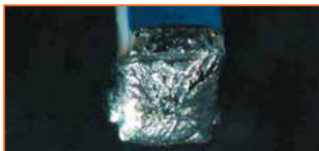
Рис. 1. Горячая деформация паяного соединения — типичный пример дефекта, возникающего из-за неправильного обращения со сборкой (изображение из стандарта IPC-A-610E)
