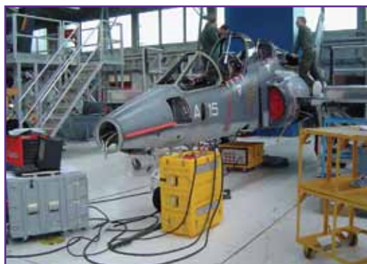
Рис. 1. Тестирование бортовой системы самолета
