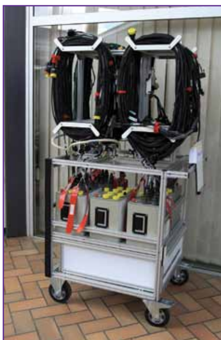
Рис. 3. Элемент системы распределенного тестирования крупных объектов
