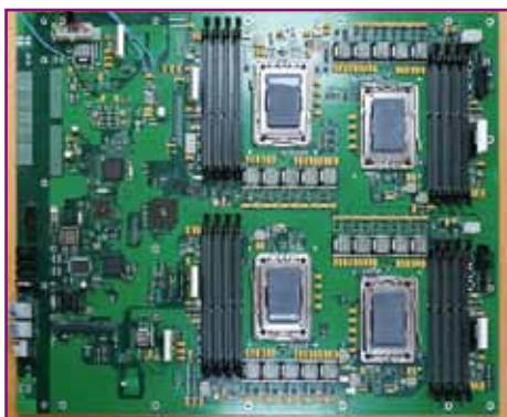
Рис. 4. Многослойная ПП супер-ЭВМ (500×600 мм, 22 слоя)
