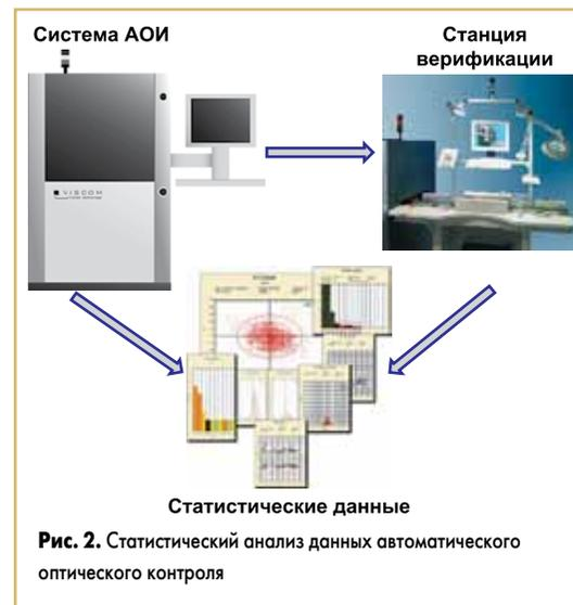
Рис. 2. Статистический анализ данных автоматического оптического контроля
