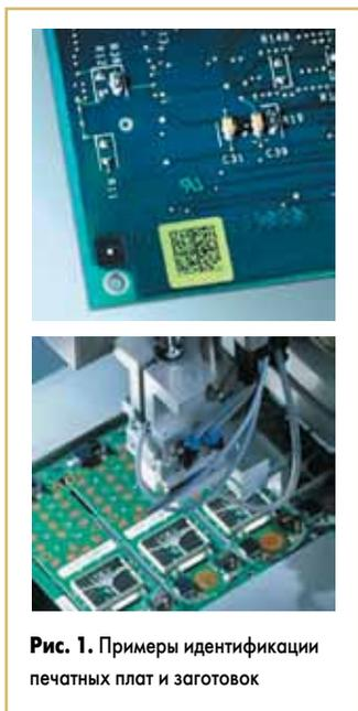
Рис. 1. Примеры идентификации печатных плат и заготовок
