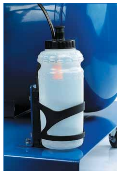
Рис. 7. Емкость для слива конденсата из фильтра-водоотделителя
