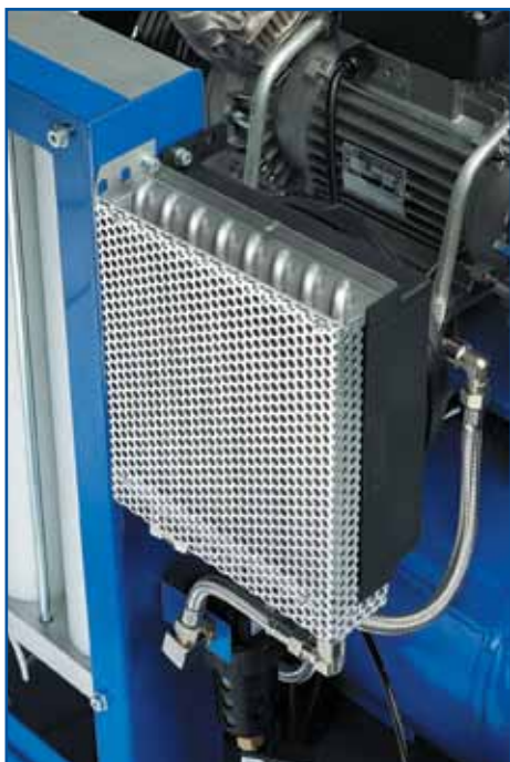
Рис. 8. Радиатор охлаждения системы осушения воздуха компрессора VT250D
