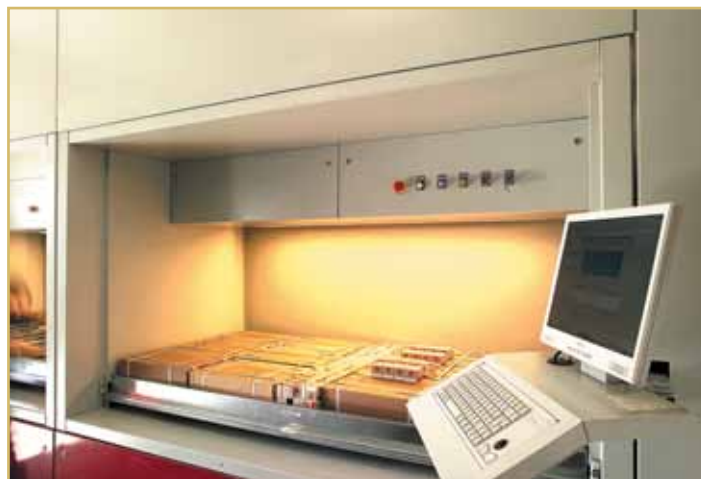
Рис. 3. Модуль управления и окно выдачи автоматизированной системы хранения лифтового типа Silo2
