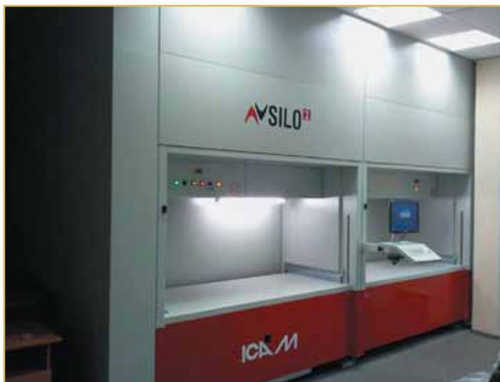
Рис. 2. Многоколонная автоматизированная система хранения лифтового типа Silo2
