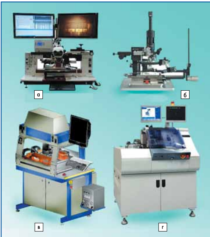
Рис. 5. Установки Flip-Chip монтажа: а) TRESKY T-3002-FC3; б) Fineplacer pico MA; в) ЭМ-4330; г) ASM ADB819-11TS
